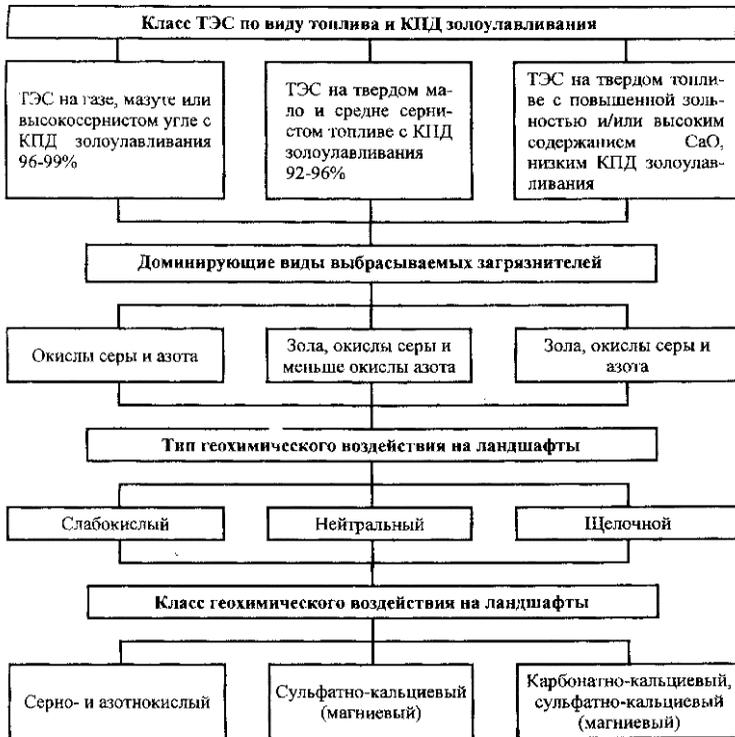
Рис. 3.8. Классификация воздействия дымовых выбросов ТЭС на природную среду
